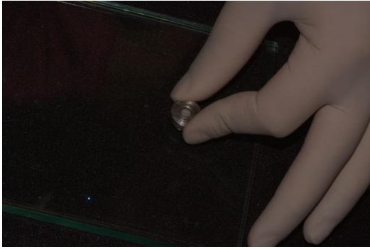
Figura 1: Estandarización de resina en loseta de vidrio
