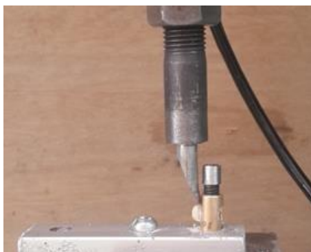
Figura 8: Máquina de Ensayo Universal Instron utilizada para prueba de cizallamiento
