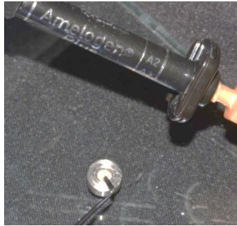
Figura 1. Colocación de primera capa de resina en el molde metálico
