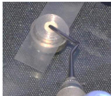
Figura 4. Estandarización de resina con tira de celuloide
