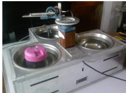
Figura 1: Tratamiento de especímenes en termocicladora
