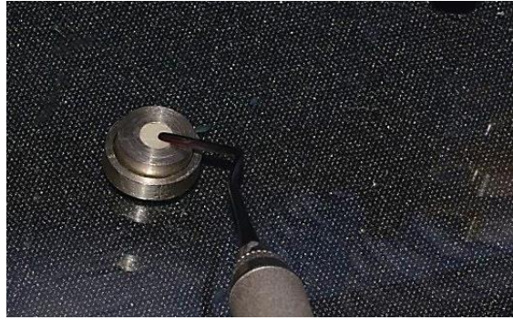
Figura 2: Inserción de resina en la matriz metálica
