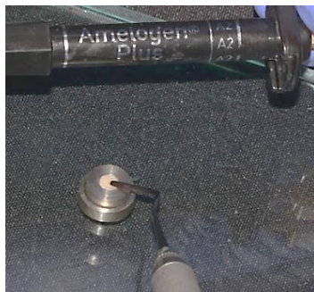
Figura 3. Aplicación de la segunda capa de resina
